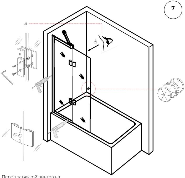
Перед затяжкой винтов на петлях произвести регулировку подвижной створки, выравнивая ее в один уровень со стационарной дверцей по верхней плоскости профиля.
